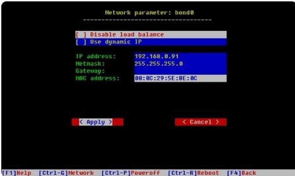
图 3.12 配置负载均衡网卡的网络参数
