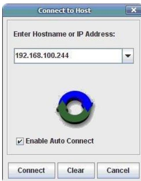
图 4.151 连接 GS9100 存储系统上的光纤控制卡进行管理
