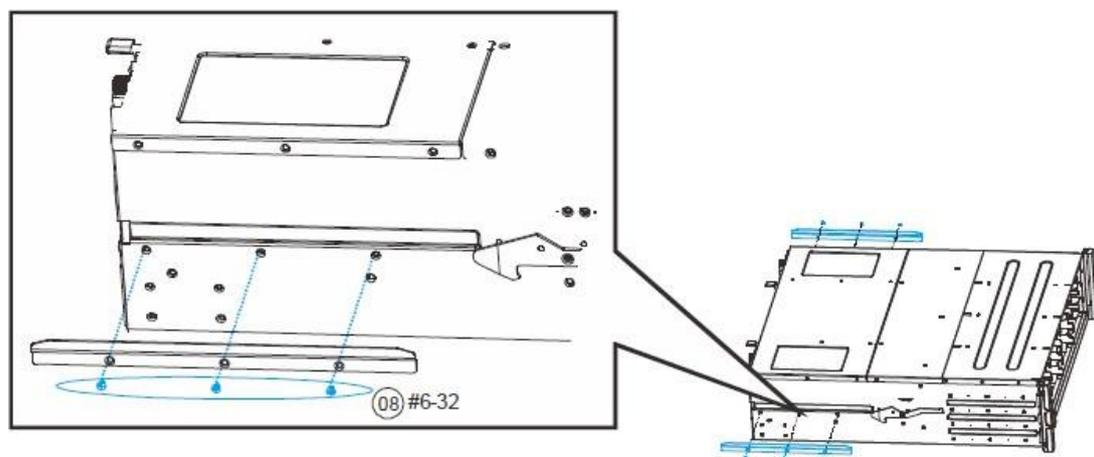
图 2- 5.机箱尾部固定装置安装
