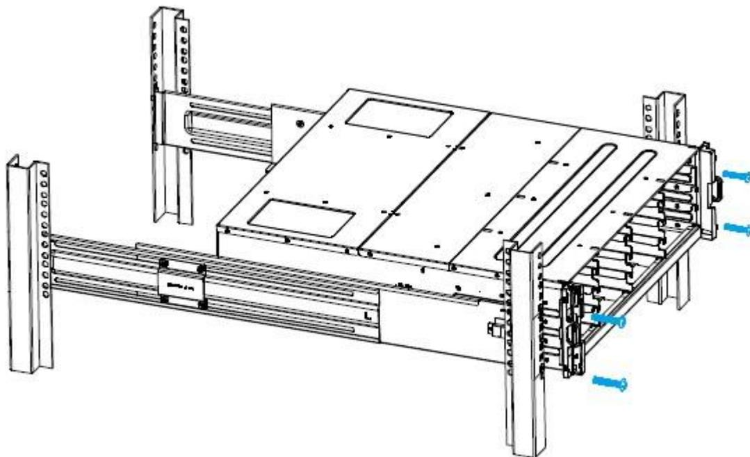
图 2-6. 上架安装以及前面板固定
