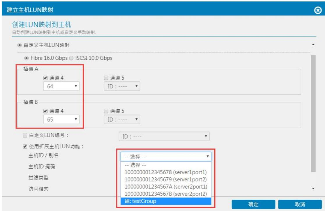
图 3-107.存储装置-自定义主机映射配置
